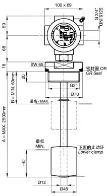
液位传感器SL1TA...B...CVS3EP和SL2TA...B...CVS3EP配备有4/20 mA信号转换器,旨在连续检查罐中液体的液位。
